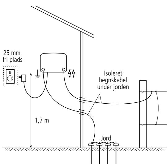
*Bemærk:* Hvis spændingsgiveren installeres indendørs, kan den strømforsynes fra et batteri i stedet for lysnettet, hvis det kræves.
