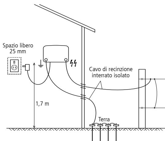
*Nota:* In caso di installazione dell'elettrificatore all'interno, potrà essere alimentato da una batteria invece che dalla rete/linea elettrica, ove necessario.
