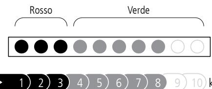
Nota: Ove fossero illuminati dieci segmenti luminosi dell'indicatore, la tensione in uscita potrebbe essere superiore a 10 kV (10.000 V).
