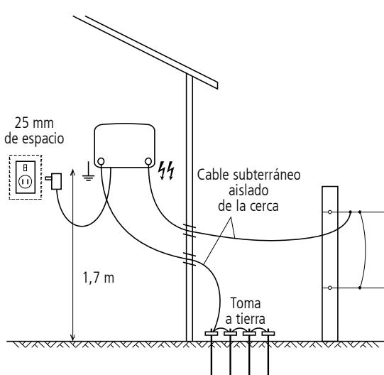
*Nota:* Si el energizador se instala en interiores, puede ser alimentado por batería (si se desea) en vez de corriente de la red.
