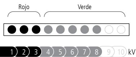
*Nota:* Si diez segmentos están iluminados, el voltaje de salida puede ser superior a los 10,0 kV (10.000 V).
