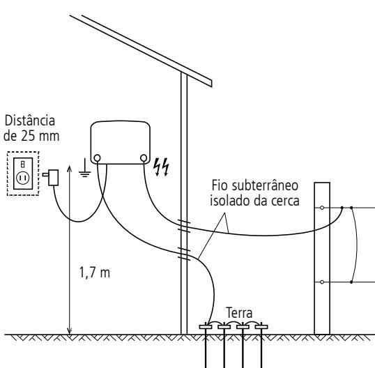
*Nota:* Se o energizador for instalado no interior, ele poderá ser alimentado por uma bateria em vez da alimentação de rede, caso necessário.
