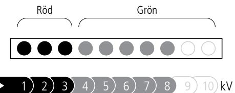
*OBS:* Om tio indikatorlampor lyser, kan utgångsspänningen vara mer än 10 kV (10 000 V).
