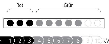
*Hinweis:* Wenn zehn Anzeigelämpchen aufleuchten, beträgt die Ausgangsspannung möglicherweise mehr als 10 kV (10.000 V).
