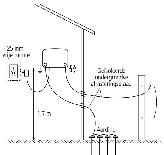
*Opmerking:* Als het elektro-afrasteringsapparaat binnenshuis wordt geïnstalleerd, kan het desgewenst met een batterij i.p.v. met de net-/lijnvoeding worden gevoed.
