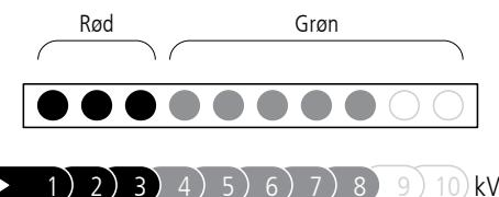
*Bemærk:* Hvis der er ti segmenter, der lyser, kan udgangsspændingen være over 10 kV (10.000 V).
