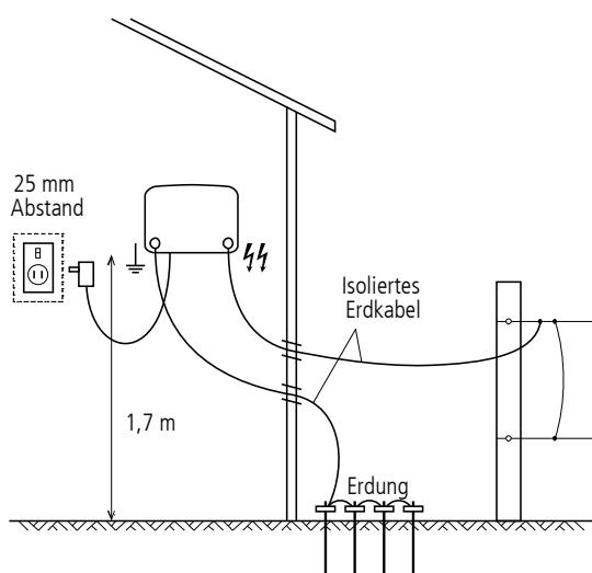
*Hinweis:* Wenn das Weidezaungerät im Innenbereich installiert wird, kann bei Bedarf anstelle von Netzstrom auch eine Batterie verwendet werden.
